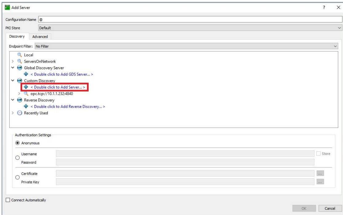
Abbildung 87: Neue Verbindung zum OPC-UA Server anlegen
